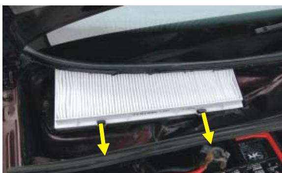
(PL) Odpiąć klipsy zabezpieczające filtr przeciwpłytkowy
